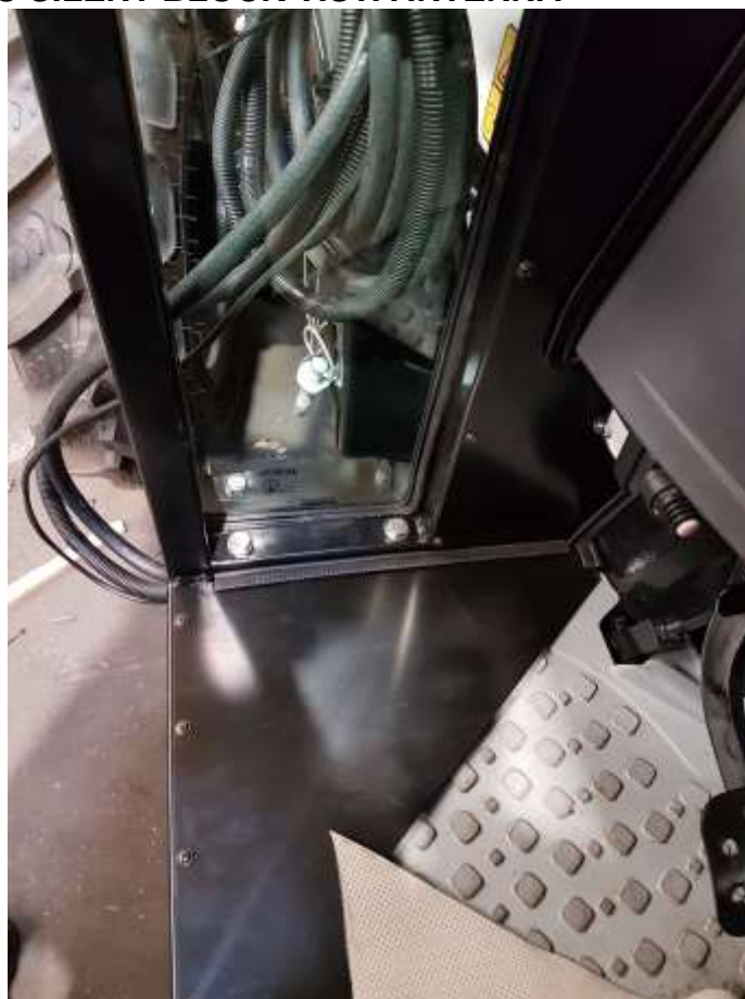
FISSAGGIO CABINA SU SILENT BLOCK VISTA INTERNA
